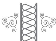
Intrinsèquement étanche à l'air, TOP AIR 4 NF fait barrière aux infiltrations d'air venant de l'extérieur et aux déperditions thermiques par convection venant de l'intérieur.
